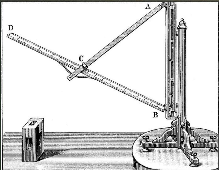
**Трикветрум** - укрепленный на Земле стационарный прибор, предназначенный для измерения на небе высоты Солнца с точностью до  $1^\circ$ .
